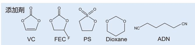
・保存試験後 負極表面の添加剤解析 Additives in Negative Electrode
